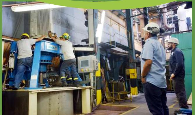
Con la colaboración del técnico representante de la fábrica BMA se realizó el desmontaje del equipo, el mantenimiento del motor, cambio de rodamientos, control de canasta, cambio de amortiguadores y sistemas de frenos para finalizar con la prueba del equipo y entrega oficial al usuario.
